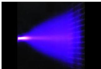
Le Flash Streamer – technologie uniquement utilisée jusqu'à alors pour la gamme Ururu Sarara – génère des électrons. Les électrons à haute vitesse rentrent en collision avec les molécules d'azote et de dioxygène présentes dans l'air. Les molécules activées vont alors déclencher une réaction chimique. La technologie Flash Streamer va décomposer les moisissures, les émissions de NOx, acariens et virus.
